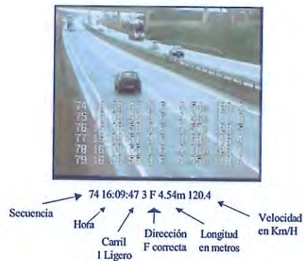
Fig. A1.7. Bucles para toma de información del tráfico vehicular en un tramo de carretera. (Fuente: Dragados concesiones. Curso avanzado en infraestructuras. UPC. 2004).
