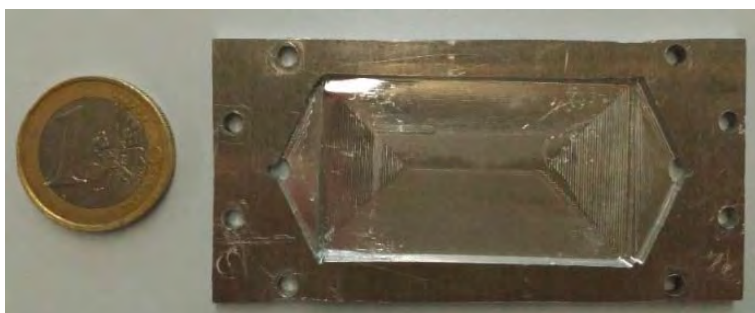
Figura 6.2.2. Mecanizado del dispositivo fotocatalítico realizado con la STEPCRAFT-2/D.300 Construction Kit.
