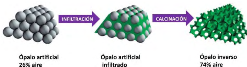
Figura 1.8.10. Fabricación de ópalo inversos ( IOs ) a partir de ópalo artificiales. De acuerdo al factor de empaquetamiento 5 de una red fcc está formada un 26% por aire y un 74% por nanoesferas, en volumen. Teóricamente un ópalo inverso debería estar constituido por un 74% por aire y un 26% por el material de relleno. Adaptada de [135].
