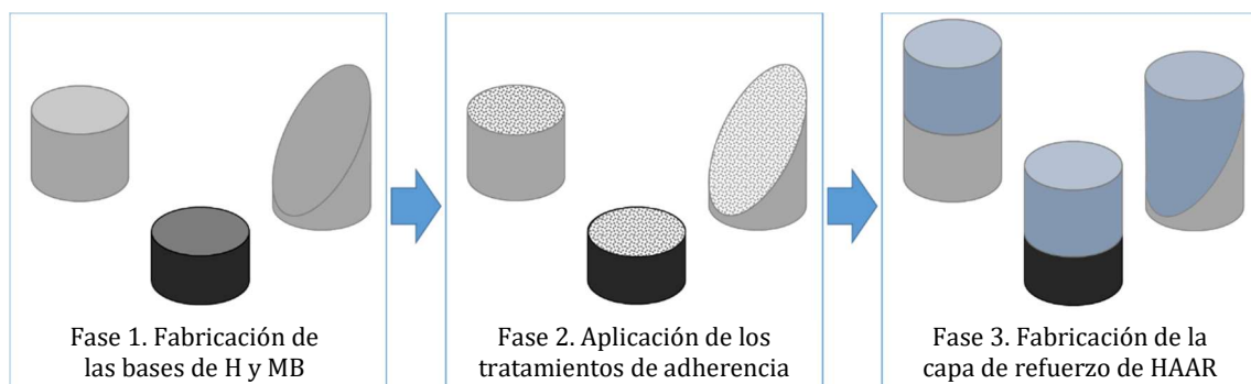
Figura 4.6 – Fases de fabricación de las probetas.
