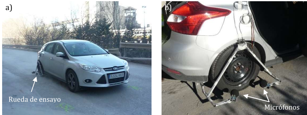
Figura 6.19 – Vehículo para medir el ruido (a). Rueda y micrófonos de grabación (b).
