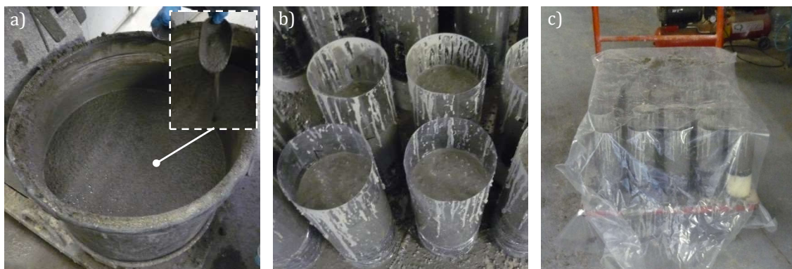
Figura 4.17 – Aspecto del HAAR en estado fresco (a), moldeado del refuerzo (b) y conservación de probetas durante las primeras 24 horas (c).
