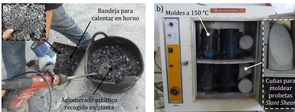
Figura 4.10 – Troceado del A (a) y calentamiento de los moldes (b).
