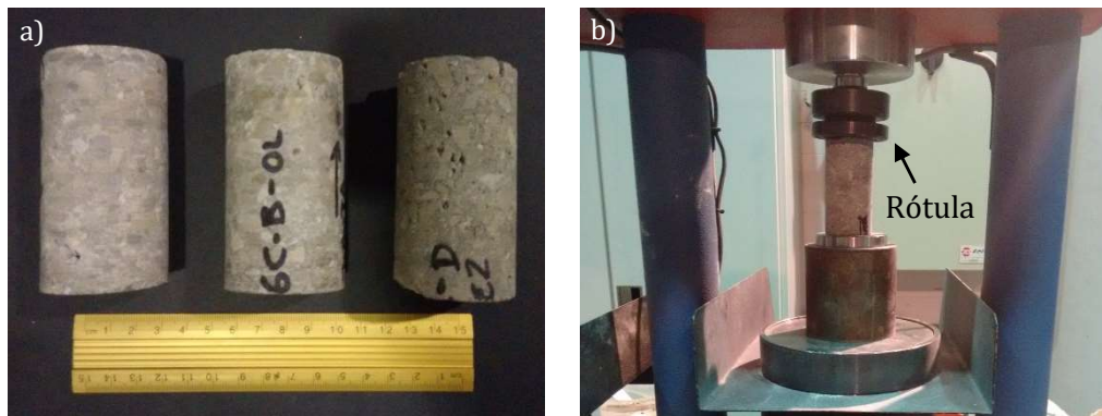
Figura 6.13 – Testigos del pavimento de la Experiencia 1: aspecto (a) y ensayo de compresión (b).
