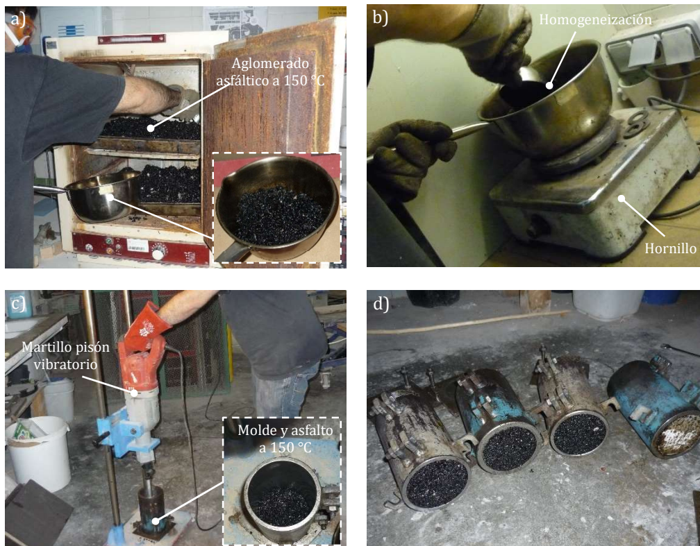
Figura 4.11 –Aglomerado Asfáltico: calentamiento (a), homogeneización manual (b), moldeado y compactación de las bases (c) y enfriamiento en los moldes (d).
