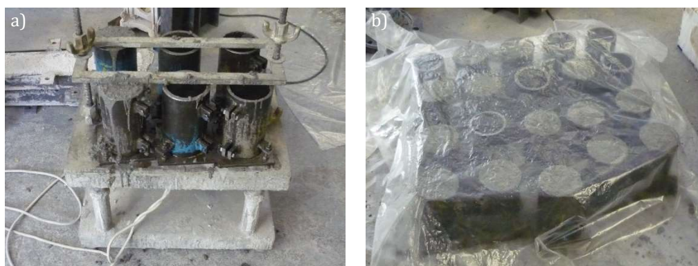
Figura 4.8 – Vibrado de las bases de H (a) y conservación durante las primeras 24 horas (b).
