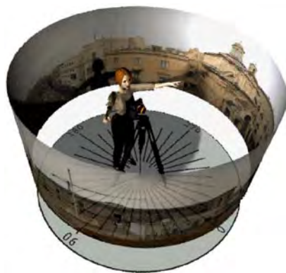
Esquema gráfico del relevamiento fotográfico para la realización de panoramas cilíndricos 360°
