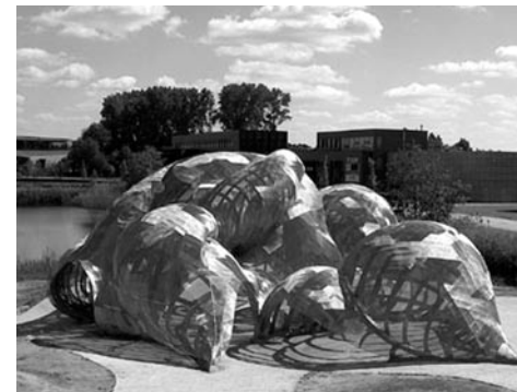
Superficies libres de dobles curvaturas (formas orgánicas generadas con NURBS) Seccionar el objeto en costillas reduce la complejidad geométrica permitiendo su materialidad con tecnologías accesibles
