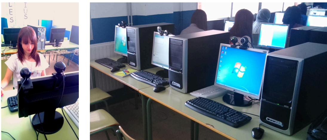
FIGURA 7.2. Imatges de la disposició dels sensors mentre es realitzaven les mesures dins l'aula de l'institut. Cada ordinador compta amb un sensor d'ultrasons i una càmera web, que s'emprà per enregistrar imatges, utilitzades en el desenvolupament de l'algorisme descrit al capítol anterior.
