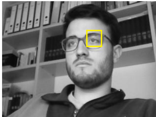
FIGURA 6.1. Correcta detecció de l'ull esquerre en el vídeo de prova mitjançant l'algorisme de Viola-Jones. [Extret de Cabrerizo, 2014].
