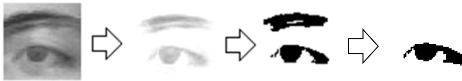
FIGURA 6.3. Procés de conversió de la imatge inicial en escala de grisos a una imatge binària pel seu processament i posterior detecció del parpelleig. En el procés es realitza una compensació de la il·luminació prèvia a la binarització, i s'elimina mitjançant una màscara la cella i possibles estructures que corresponguin a ulleres (imatge dreta). [Extret de Cabrerizo, 2014].
