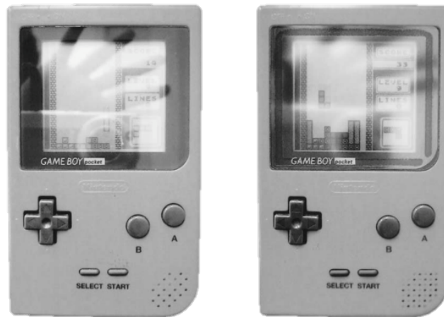
FIGURA 2.7. Diferència de reflexes amb (dreta) i sense (esquerra) l'ús de la pantalla antireflectant amb la que els autors van aconseguir incrementar el parpelleig notablement. [Extret de Tsubota et al, 2002]
