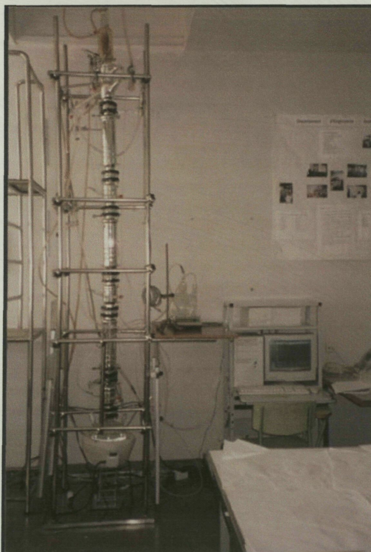
Figura 4.1.1. Planta piloto de destilación batch.
