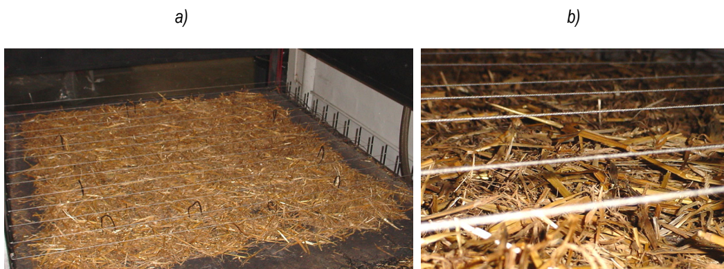
Figura 3.20. a) Llit de combustible i disposició dels fils de cotó. b) Detall dels fils.
