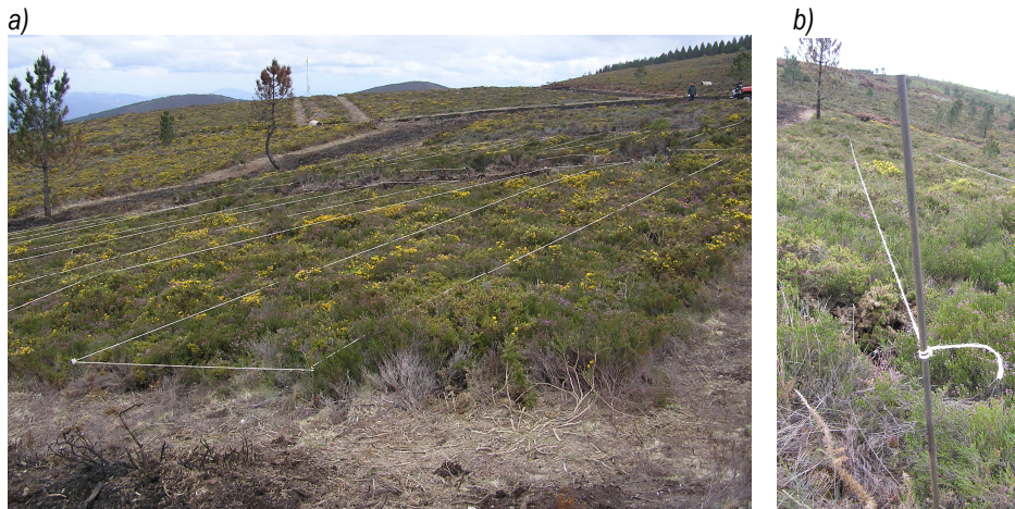
Figura 5.12. a) Parcel·la discretitzada amb fils de nylon. b) Detall d'ancoratge.
