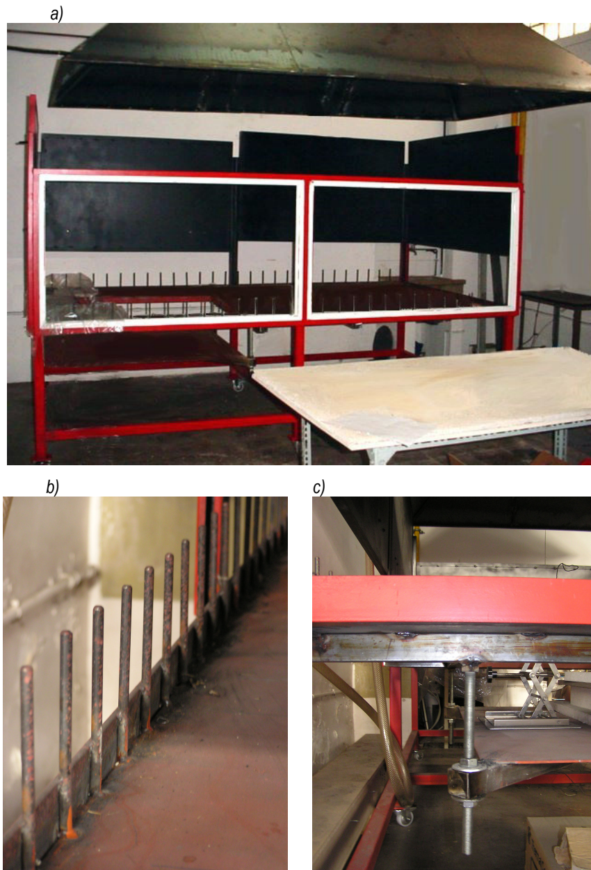
Figura 3.2. a) Vista general dels elements estructurals de la taula de combustió. b) Detall de les barres cilíndriques i la xapa. c) Detall de la superfície rígida i un peu d'ancoratge.
