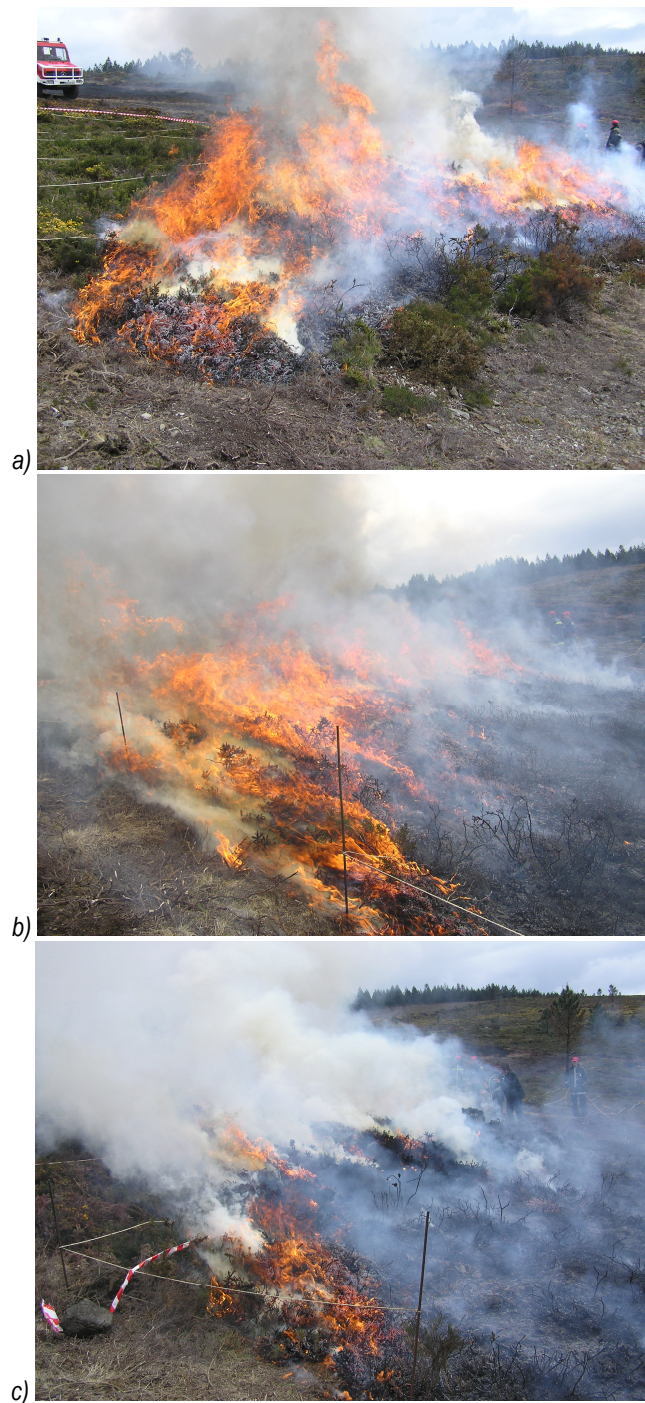
Figura 5.13. a) Ignició, b) evolució c) retard del front en l'execució d'una prova.
