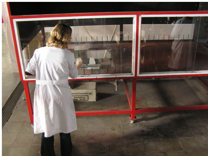
Figura 3.5. Muntatge dels quatre vidres corredissos.
