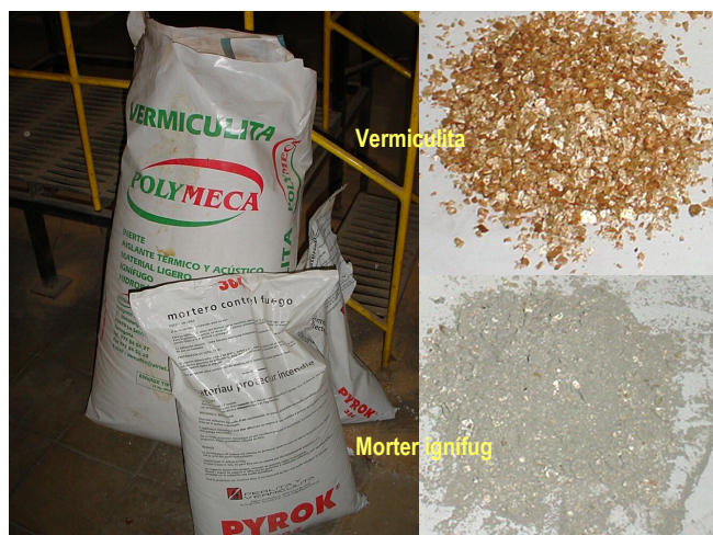
Figura 3.7. Matèria primera per a l'elaboració de la ceràmica de pavimentació.
