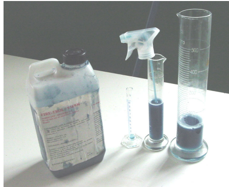
Figura 3.23. Bidó de retardant, polvoritzador i provetes.
