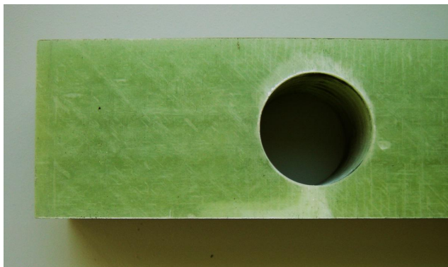
Figura 5.37: Delaminaciones probeta MN2
