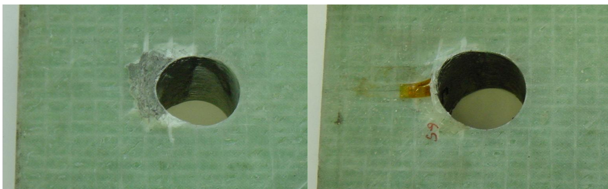
Figura 5.14: Fallo de las probetas tipo AB1 y AB
