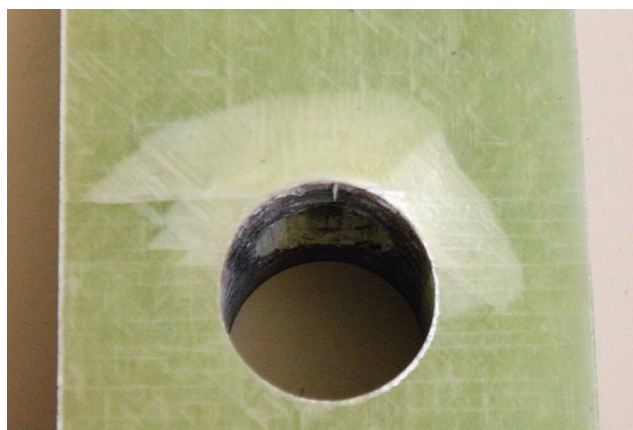
Figura 5.30: Fallo probeta MB
