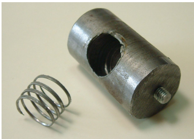
Figura 5.26: Fallo del bulón a cortante
