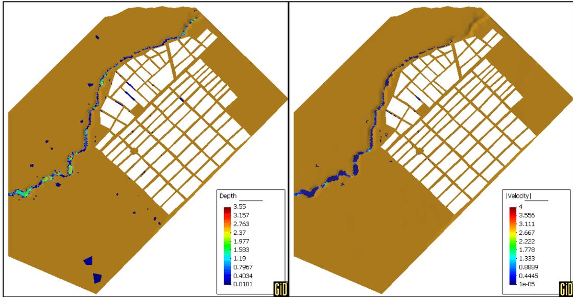
Figura 8.59 Calados (izquierda) y velocidades (derecha) para  $t=10000$ s.
