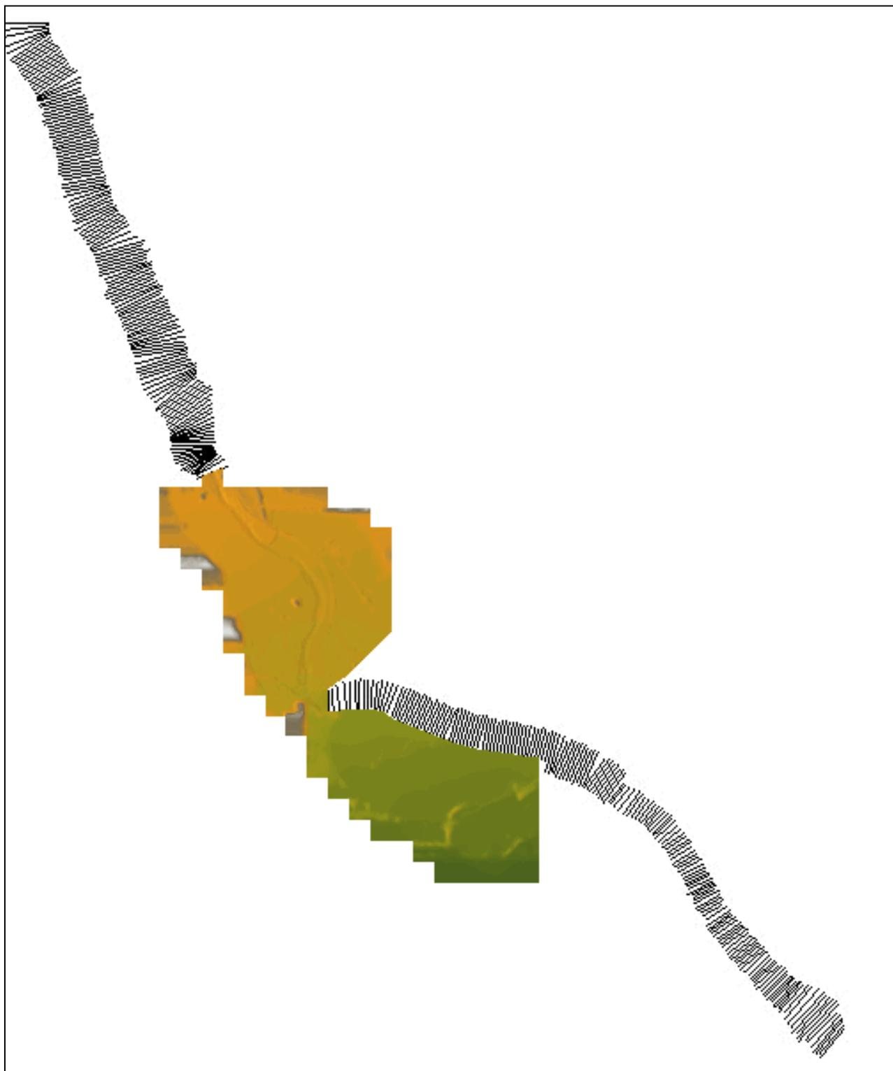
*Figura 8.69 Discretización del tramo de estudio. Disposición relativa entre los tramos 1D y la zona 2D.*
