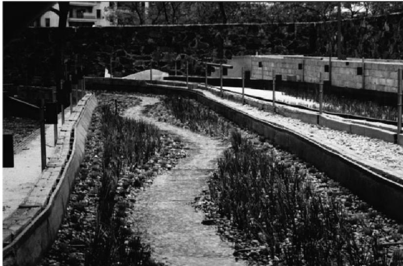
Fotografía 7.5. Modelo reducido del río Besòs. Fotografía tomada de (Martín-Vide et al., 2004)
