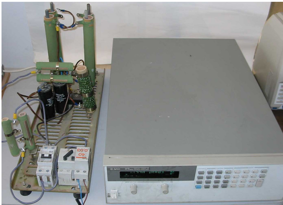
Figura 182. Fotografia de la càrrega no lineal i de la font de tensió alterna.
