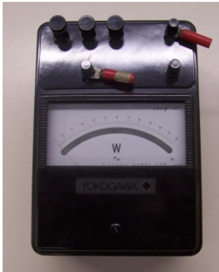
**Figura E-2.** Fotografía del vatímetro de bajo factor de potencia Yokogawa 2041
