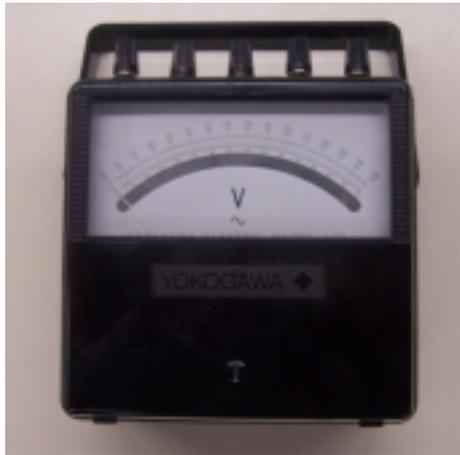
*Figura 10-2. Voltímetro de flujo*
