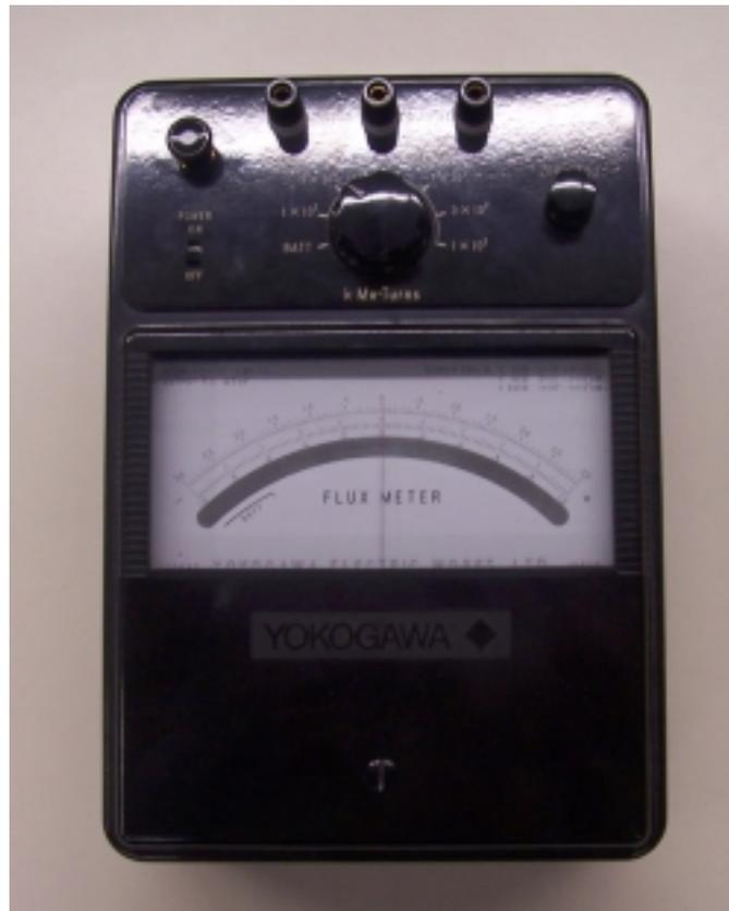
**Figura E-1.** Fotografía del fluxometro Yokogawa 3254
