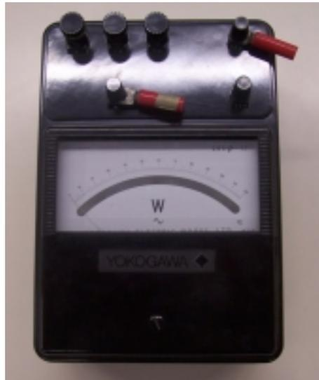
**Figura 10-4.** *Vatímetro de factor de potencia bajo Yokogawa tipo 3254*
