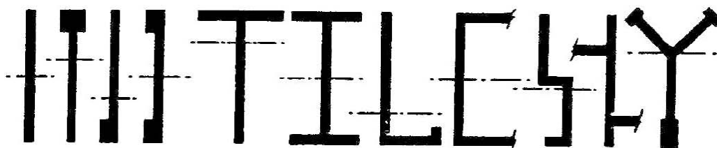
Figura 2.42 Secciones comunes de muros estructurales [Paulay y Priestley, 1992]
