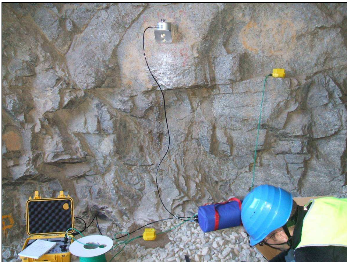
Figura 8.7: Muestra de los diferentes métodos de fijación de los sensores: fijado con un soporte metálico, pegado con cinta adhesiva en una repisa y anclado al balasto de la vía del tren cremallera.
