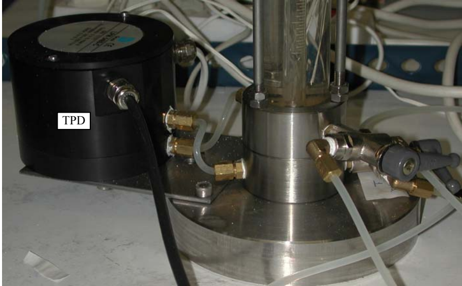
Figura 3.25 Detalle de conexión de transductor de presión diferencial TPD con bureta de doble cámara.
