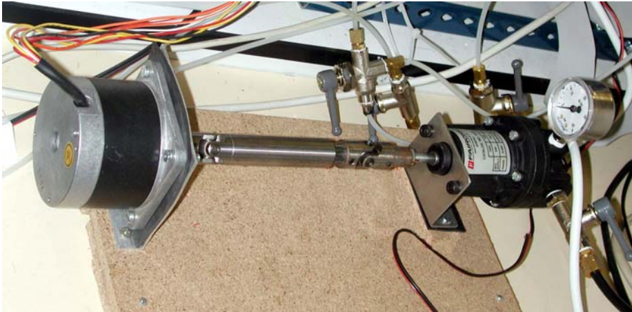
Figura 3.11 Sistema de motor paso a paso modelo HN 200-3426-0140 AX08, ligado a un módulo controlador bipolar GS-DC200, operando sobre un regulador de alta presión (rango de trabajo: 35 kPa hasta 2.8 MPa). Es usado para controlar la presión de confinamiento o presión de agua (en traslación de ejes).
