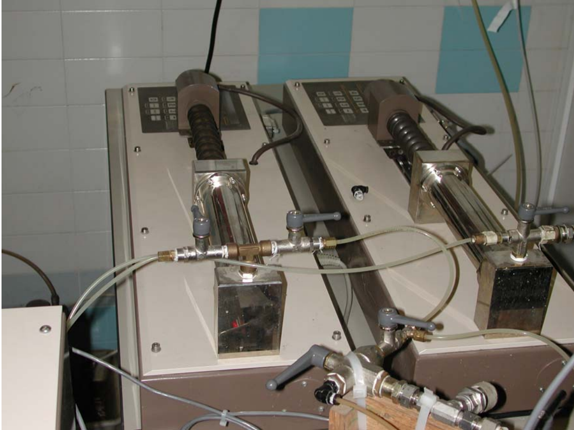
Figura 3.37 Controladores digital de presión y volumen, utilizados para imponer presión de confinamiento y presión de cola.
