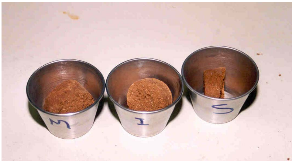
Figura C.6 Obtención local del contenido de agua de la muestra al final del ensayo.
