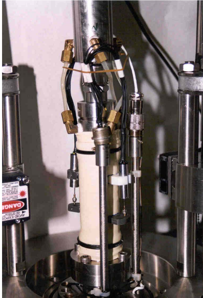
Figura C.5 Célula triaxial parcialmente ensamblada, mostrando la instrumentación interna.
