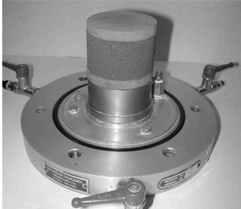
Figura A.1 Probeta ( $\phi = 70$  mm,  $h = 40$  mm) antes de la compactación isotrópica.
