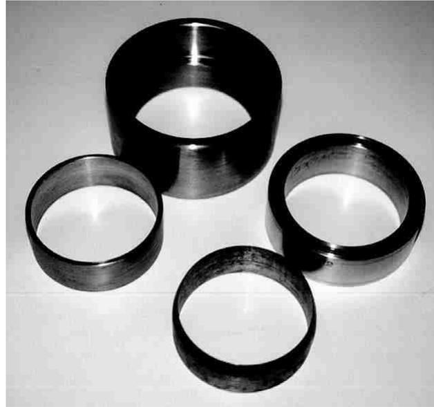
Figura A.3 Sistema de anillo de acero inoxidable utilizado para labrar una probeta edométrica de una probeta compactada en condiciones isotrópicas.
