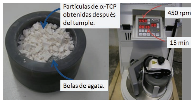
Figura 3.1: Molino empleado en la molienda del \alpha -TCP bajo el protocolo 15:450. Para una buena eficiencia las partículas de \alpha -TCP deben ser colocadas sobre las bolas de ágata.
