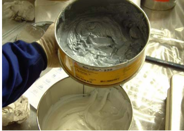
Figura 3.29 — Componentes a y b de la resina epoxi bi-componente 3:1.
