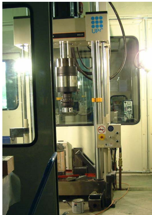
Figura 3.40 — Máquina de ensayos utilizada en la campaña rotura de probetas reforzadas con tejidos y laminados CFRP.
