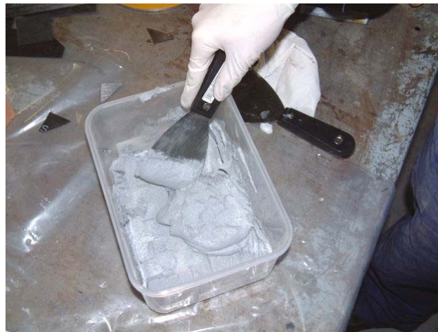
Figura 3.31 — Resina epoxi bi-componente 4:1.
