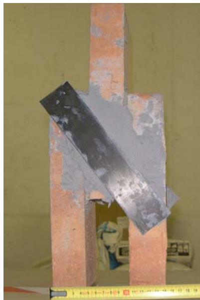
Figura 4.23 — Probeta reforzada con laminado CFRP aplicado en sentido diagonal a la dirección de la carga y a las juntas de mortero.
