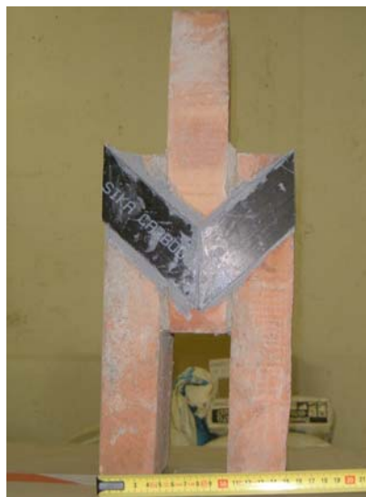
Figura 4.25 — Probeta reforzada con laminado CFRP aplicado en dos segmentos contrapuestos en diagonal y apuntados hacia la base en las dos caras.
