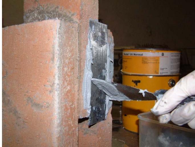
Figura 3.37 — Aplicación del laminado de fibra de carbono sobre la superficie de la probeta.
