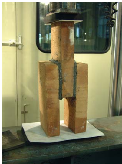
Figura 4.17 — Probeta no reforzada situada bajo el actuador dinámico antes de ser ensayada.
