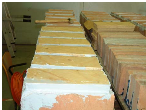
Figura 3.71 — Probetas reforzadas con placas de madera micro-laminada.
