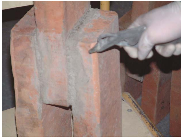
Figura 3.32 — Limpieza de las probetas con aire comprimido.
