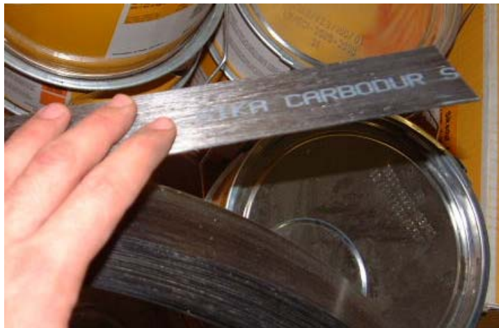
Figura 3.28 — Laminado compuesto de fibra de carbono.
