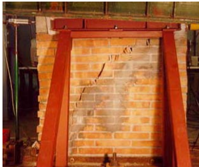
Figura 4.9 — Rotura del panel 4.
