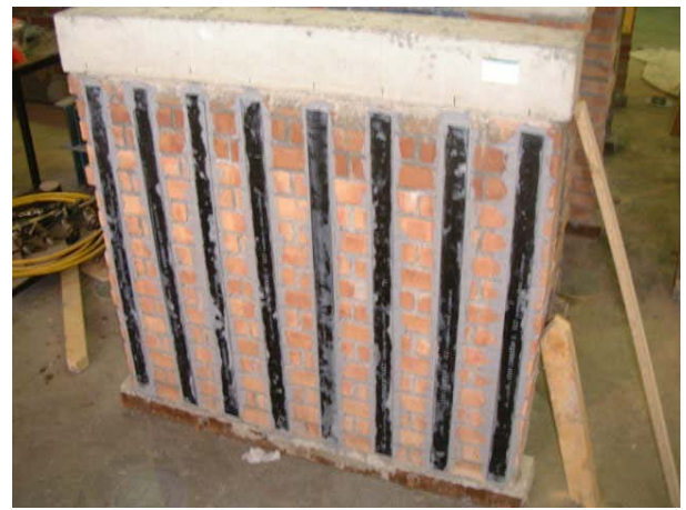
Figura 3.46 — Refuerzo terminado de los paneles 9 (a) y 10 (b).
