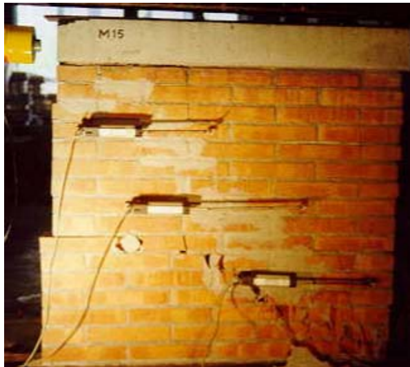
Figura 4.7 — Rotura del panel 3.
