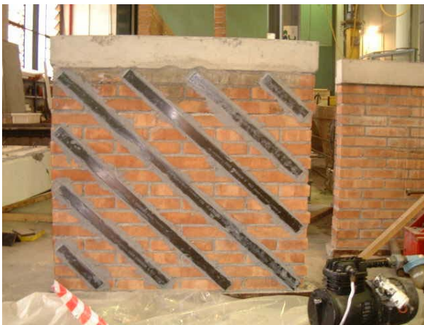
Figura 3.46 — Refuerzo terminado de los paneles 9 (a) y 10 (b).
