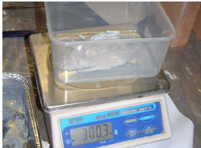
Figura 3.34 — Utilización de una báscula de precisión para dosificar los componentes.
