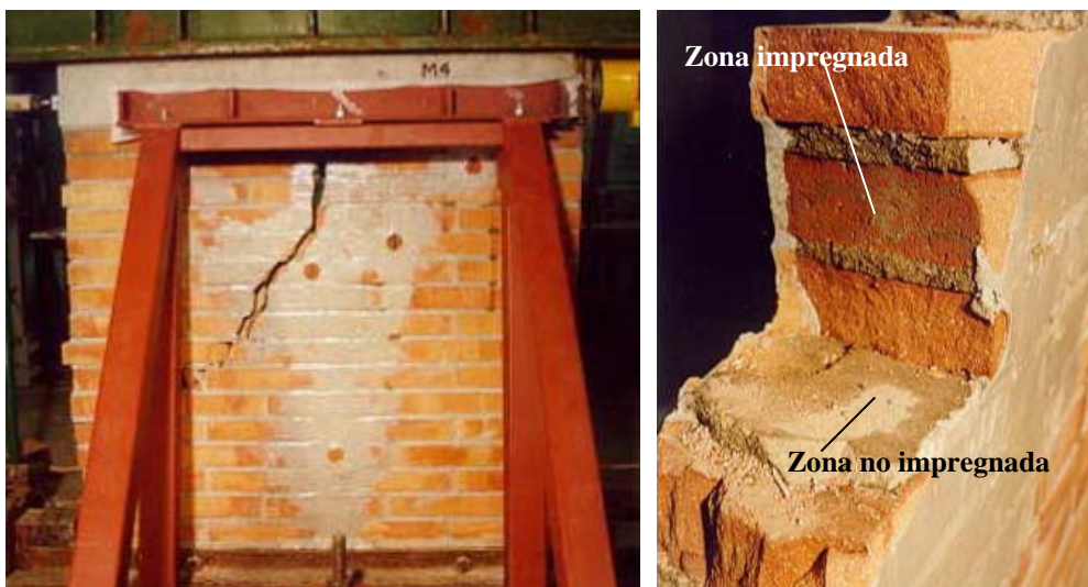
Figura 4.15 — Rotura del panel 7.
