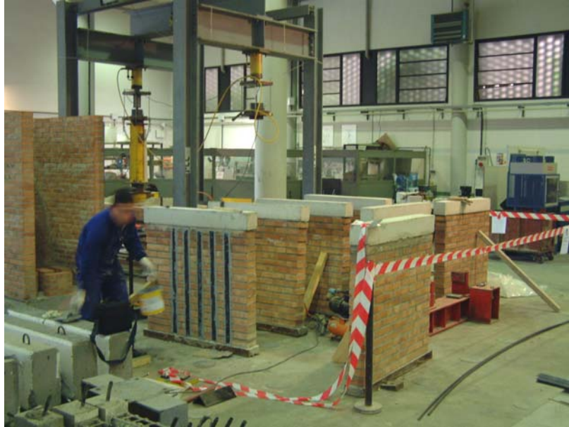
Figura 3.43 — Área de trabajo en laboratorio, proceso de refuerzo de paneles.
