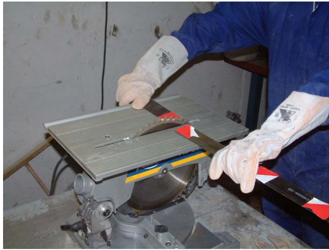
Figura 3.33 — Corte del laminado de fibra de carbono en sierra circular.
