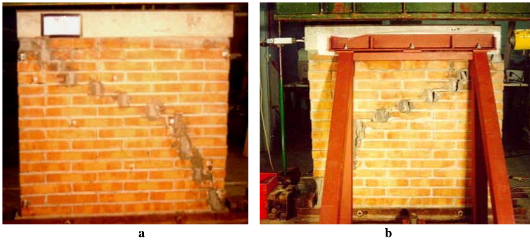
Figura 4.2 — Panel 1 reparado antes de ser ensayado (a); rotura después del ensayo (b).
