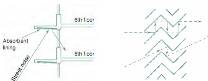
Figura 3.77 - Superficies absorbentes en forros de varandas y lamas de venecianas. Fuente: SZOKOLAY, 2008.
