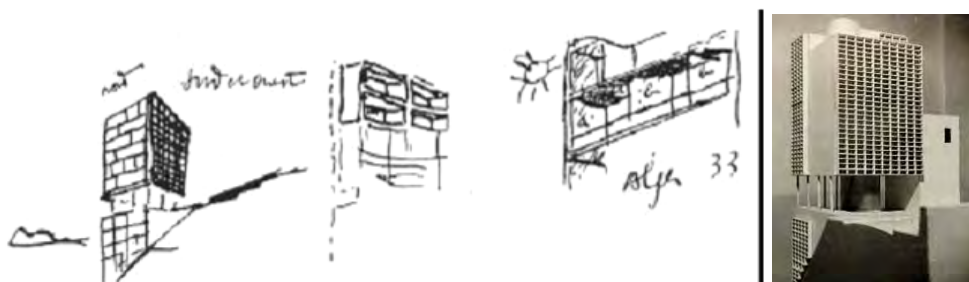
Figura 1.28 - Croquis y maqueta de Le Corbusier para Argel, hito de la creación del brise-soleil . Fuentes: OLGAYAY y OLGAYAY, 1973 y Fondation Le Corbusier.
