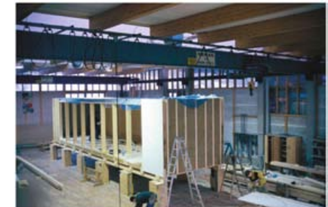
Fabrication d'une unité modulaire SU-SI chez le constructeur Michael Kaufmann photo : J. Kaufmann Architektur Fabricación de módulos SU-SI con predominio de madera (Kaufmann)
