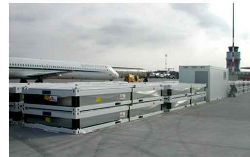
Módulos estándar plegados para transporte en avión. Vivienda de emergencia.
