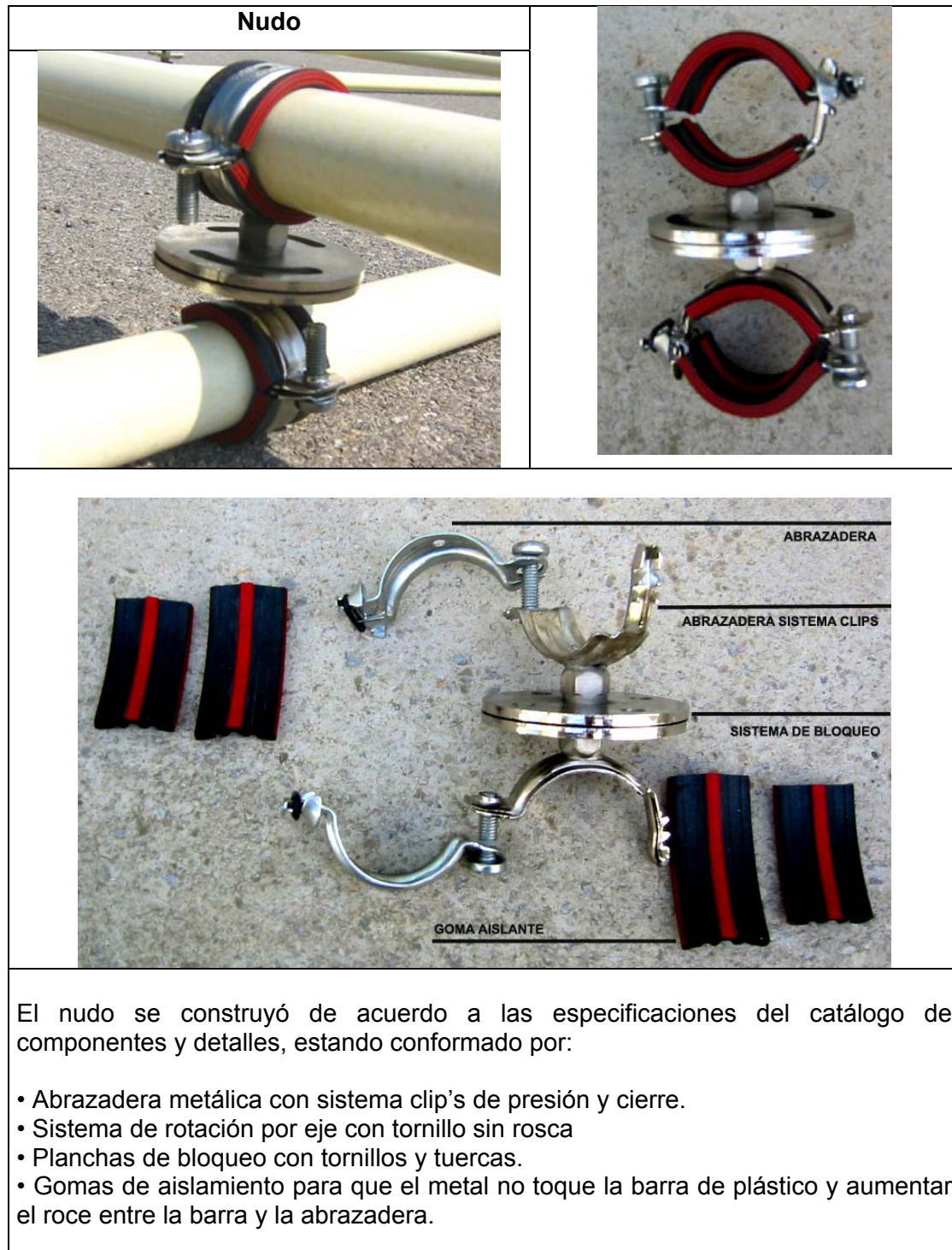
Figura N° III-29: Armado del nudo de la malla
