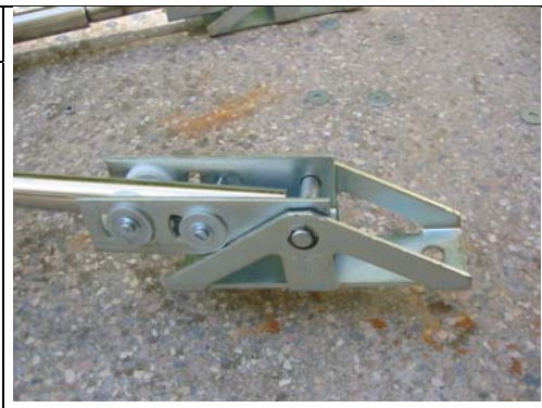
Figura N° III-30: Armado de la pieza terminal de la barra de los arcos perimetrales
