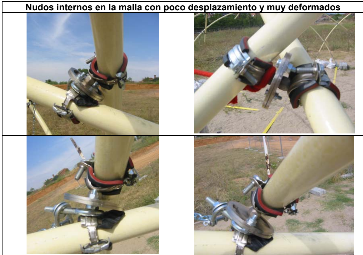
Figura N° III-39: Deformación en los nudos de la malla
