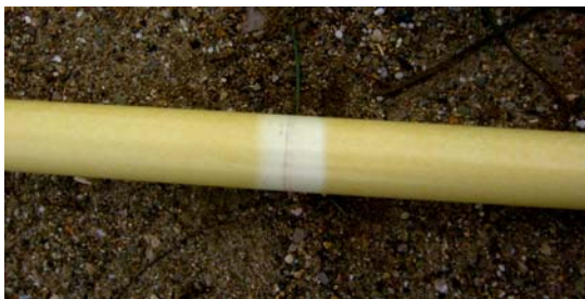
Figura N° III-47: Cambio de color en las barras
