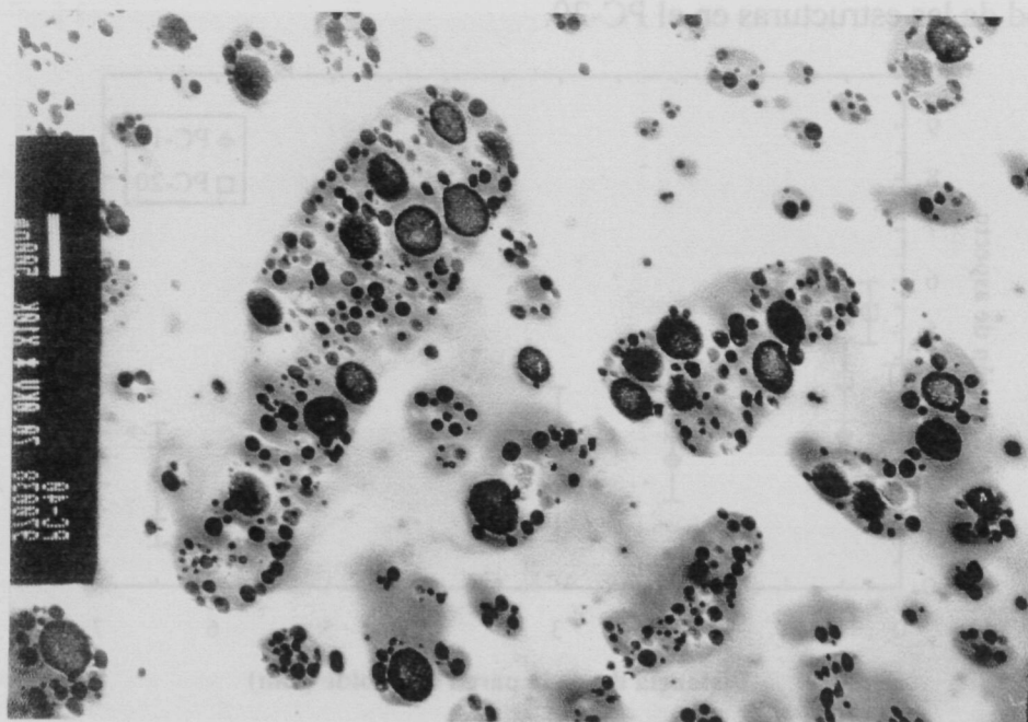
Figura 5.3.10.- Microfotografía TEM del PC-40. Barra de escala equivale a 500 nm.
