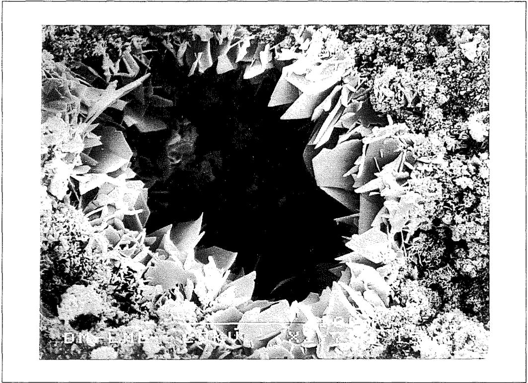
*Figura 4.45. Detalle de la microestructura observada para la muestra A134 a las 64 horas de iniciada la reacción de fraguado. (x2700)*
