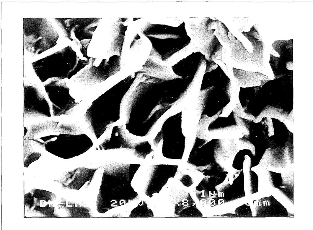
Figura 4.50. Detalle de los puntos de unión entre cristales observados, en superficie, para la muestra A134 a las 120 horas de iniciada la reacción de fraguado. (x8000)
