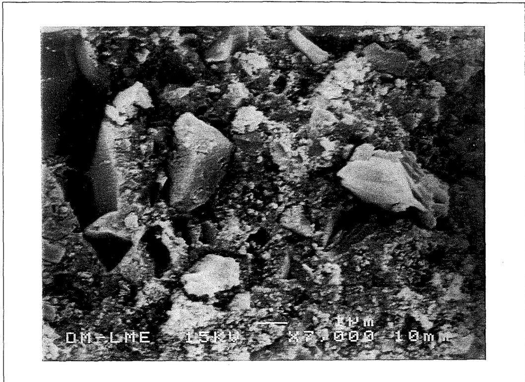
Figura 4.53. Detalle de la microestructura observada para la muestra B134 a las 16 horas de iniciada la reacción de fraguado. (x7000)
