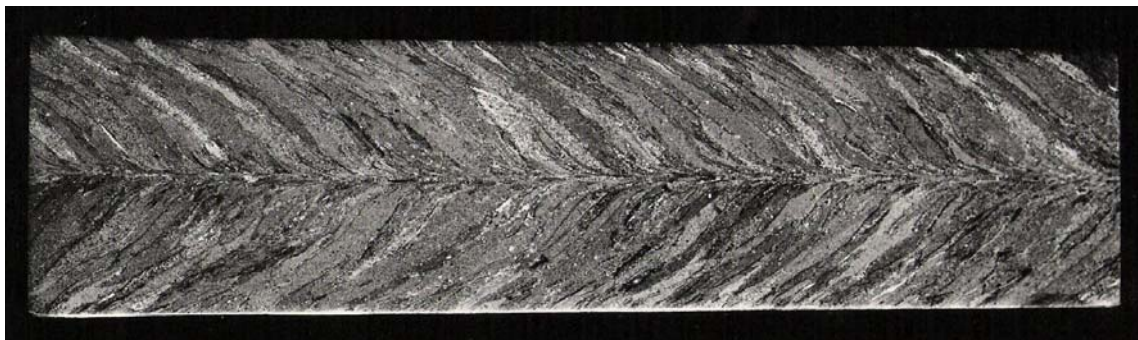
Figura 3. 3 Orientación de la solidificación en un lingote obtenido por ESR
