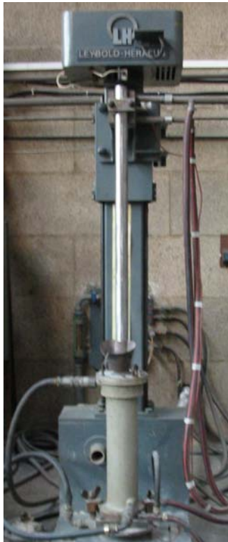
Figura 3. 4 Proceso de refusión por electro-escoria para la producción del acero C
