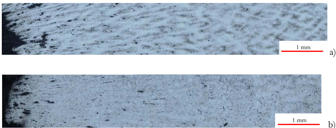
Figura 4. 5 Metalografías de las probetas del acero A1 ensayadas a 1000°C tras un recalentamiento a a) 1100°C y b) 1330°C y atacadas con el reactivo 2
