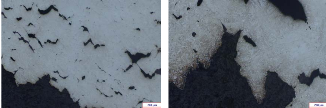
Figura 4. 7 Metalografías de las probetas ensayadas a 900°C tras recalentamientos a a) 1000°C y b) 1330°C
