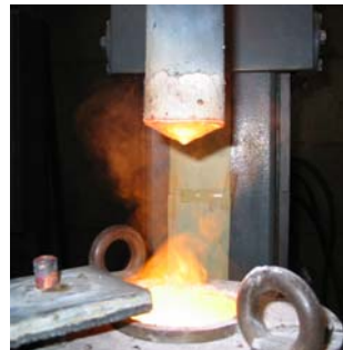
Figura 3. 4 Proceso de refusión por electro-escoria para la producción del acero C
