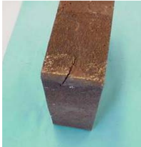
Figura 3. 1 Grietas transversales que aparecen en las esquinas de algunas palanquillas
