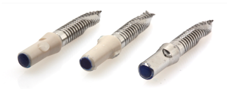
Figura 15. Montaje de las muestras. Acople entre implante y aditamento protésico con la punta de papel absorbente de color blanco en el interior (Roeko Hanel Coltène, Langenau, Alemania). Sellado del orificio de encaje mediante PTFE y composite (Tetric Evo Ceram Ivoclar Vivadent, Schaan, Liechtenstein).
