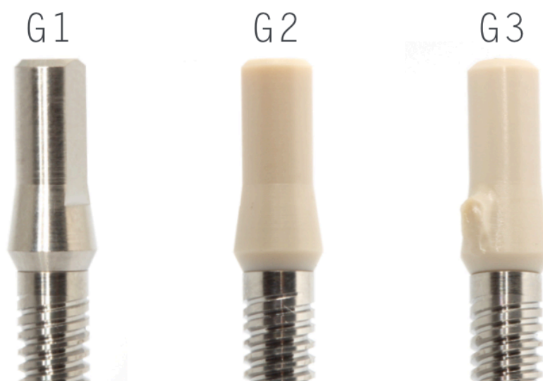
Figura 13. Grupos de estudio G1 Titanio G2 PEEK prefabricado G3 PEEK OPTIMA® LT1 personalizado (CAD-CAM).
