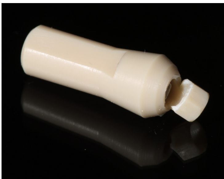
Figura 17. Pilar protésico de PEEK prefabricado (G2) tras ser sometido a compresión hasta fractura.
