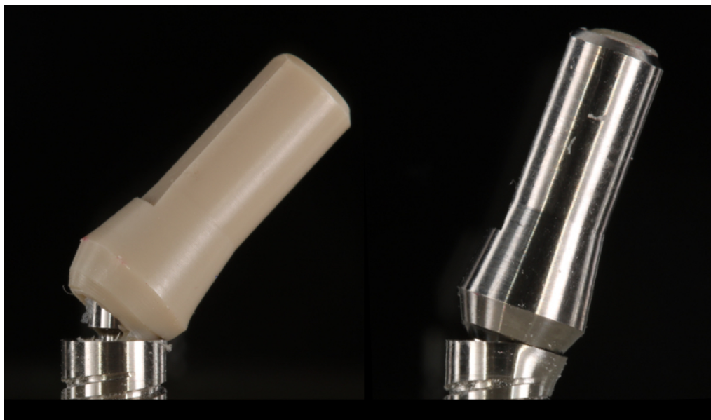
Figura 31. Ensayos de compresión a rotura de los pilares de PEEK y titanio.
