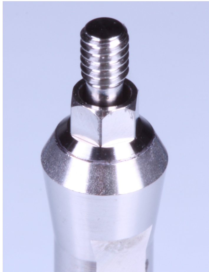
Figura 41. Imágenes de dos muestras de titanio (G1) sin rastros de microfiltración. Estas imágenes fueron adquiridas mediante cámara fotográfica Canon EOS 600D con Canon Macro Lens EF 100mm (Canon Corp. Tokyo, Japón).
