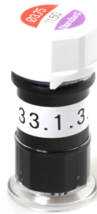
Figura 14. Muestra con su código correspondiente. Los números de identificación indican el orden a estudiar, el material del cual está compuesto, el torque aplicado y si han sido sometidos a carga cíclica.
