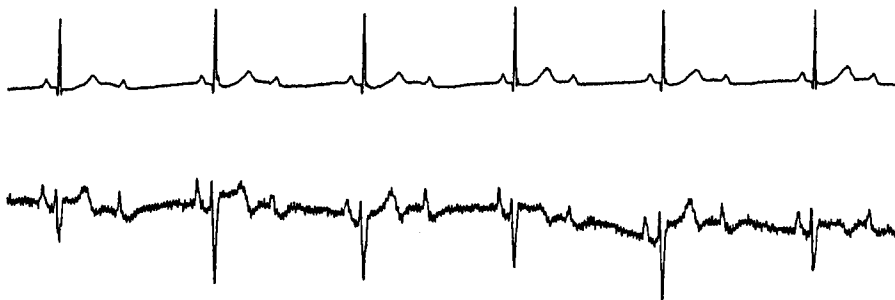
Figura 3.2: Registro de ECG de la base de datos MIT-BIH. Canales 0 y 1.
