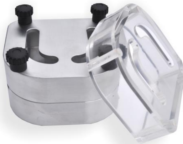
Figura 3 Mufla utilizada para el encofrado de las barras
