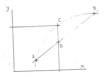
Tenemos dos puntos A, B sobre una curva, una interpolación lineal tendría como resultado trabajar con el punto D en vez de con C, veámos por que.
