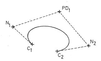
Es suficiente añadir un nuevo vertice interior para aumentar el orden de la curva, cualquier cambio de posición de uno de los vertices del poligono afecta a la forma de la curva entera.
