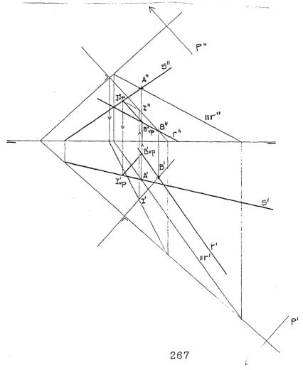
Algunos autores, para no complicar excesivamente el dibujo, realizan las operaciones de obtención de la dirección de la perpendicular aparte mediante paralelas a las dos rectas, en vez de mantener una y por ella trazar la paralela a la otra:
