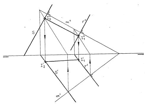
El plano  $\alpha$  perpendicular, donde se encontrarà la perpendicular común, lo trazamos en cualquier posición, posteriormente lo intersecamos con r y s, los punto  $I_1$  e  $I_2$  están a la distancia buscada, la obtendremos de la forma habitual.
