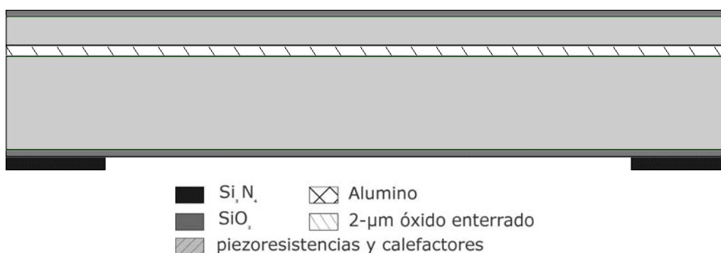
Figura 4.3.a: Corte transversal del dispositivo una vez ha sido grabada la capa de nitruro de silicio con máscara KOH en la cara dorso
