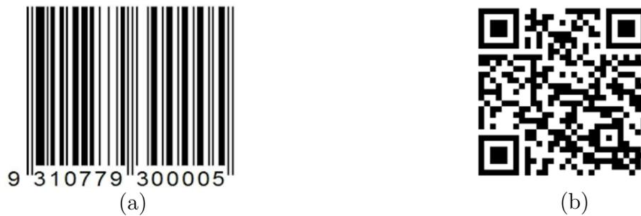
**Figura 2.1.** Estructuras de códigos de barras: (a) unidimensional con codificación EAN 13 y (b) bidimensional (QR).
