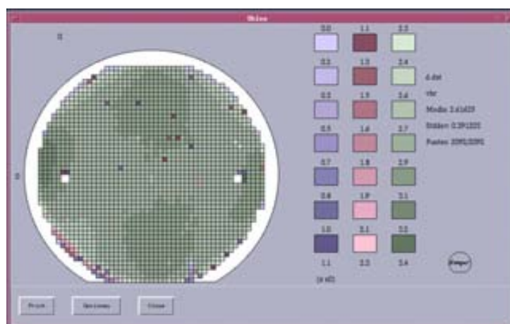
Figura 3.18: Cartografía de la oblea 6 del primer proceso. Valores de la tensión para 10 mA.
