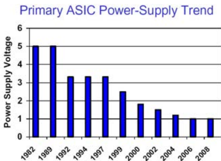
Figura 1.1: Tendencia de la tensión de alimentación. 2004 IBM corporation.
