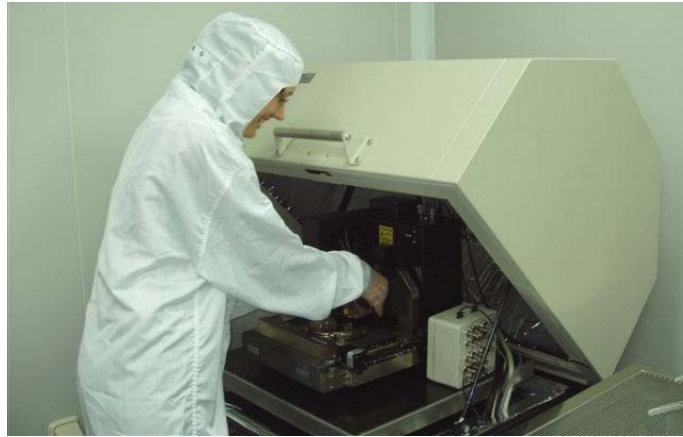
Figura 3.11 Microscopio de Fuerzas Atómicas del laboratorio de Nanofabricación en el Instituto de Microelectrónica de Barcelona.
