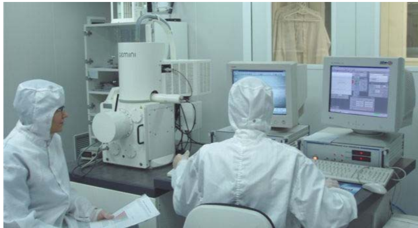
Figura 3.13 Equipo de litografía por haz de electrones basado en un microscopio de electrones de barrido en el Laboratorio de Nanofabricación del Instituto de Microelectrónica de Barcelona.
