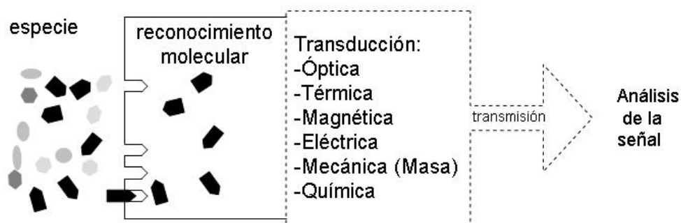
Figura 2.4 Modelo general de un sensor químico: se distinguen tres bloques: el reconocimiento molecular, la transducción y el procesado de los datos.
