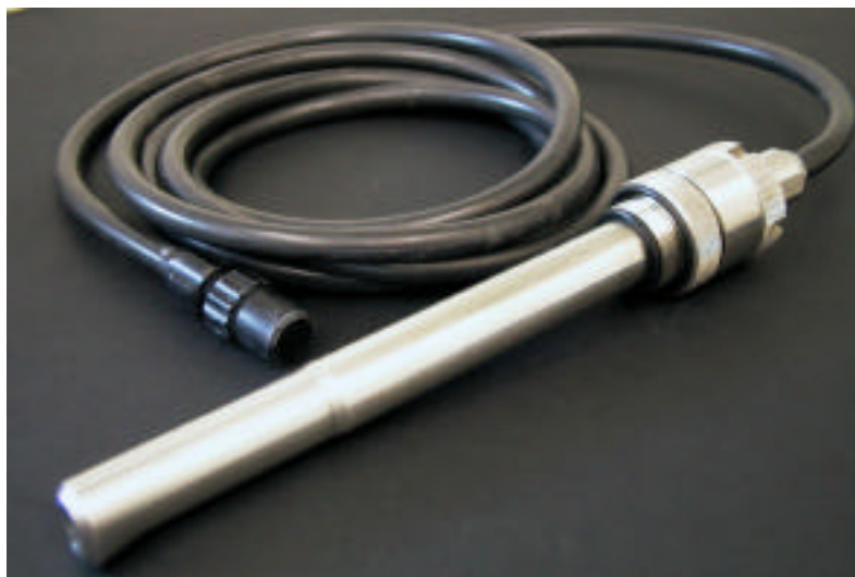
Figura 8.5. Sonda Aquasant AF44 CS/R amb peça adaptadora a la tapa del Biostat MCD.
