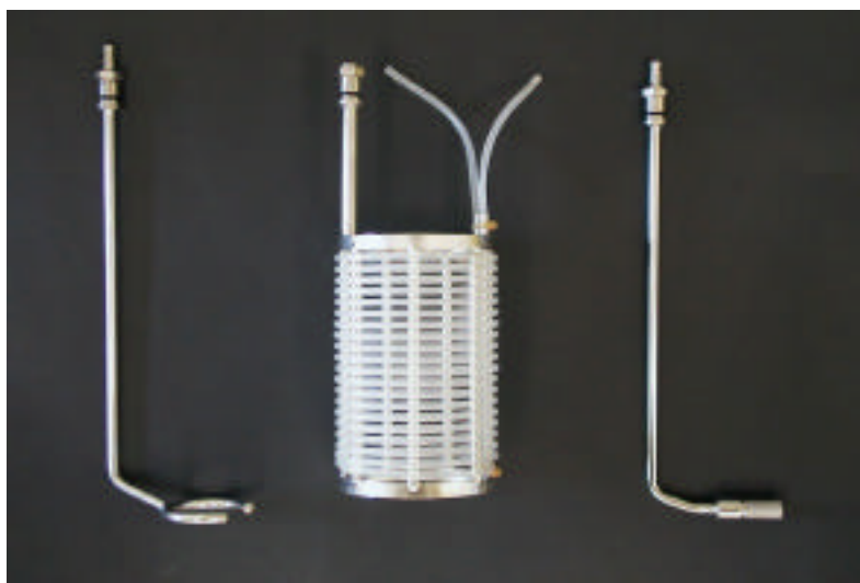
Figura 8.3. Diferents sistemes de bombolleig. D'esquerra a dreta es mostren el difusor d'anell perforat, la membrana tubular de silicona i el microdifusor.
