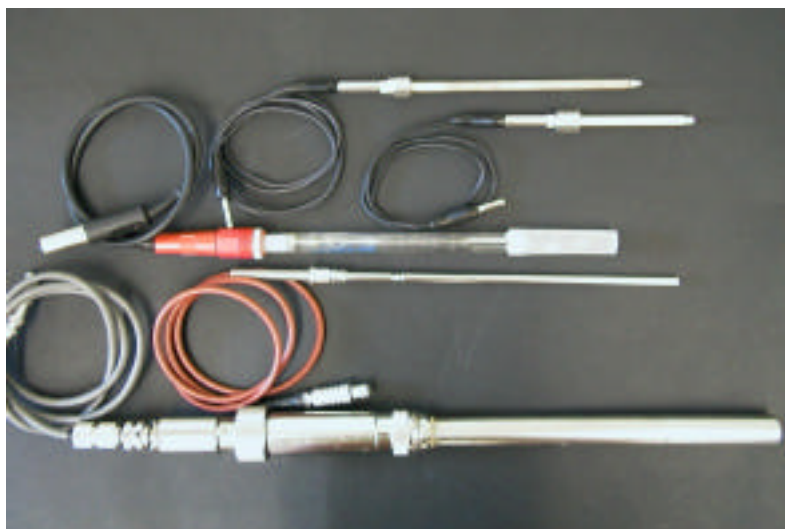
Figura 8.2. Elements de mesura del Biostat MCD. Començant per dalt: sensor de nivell #1, sensor de nivell #2, sonda de pH, sensor de temperatura i sonda de pO 2 .
