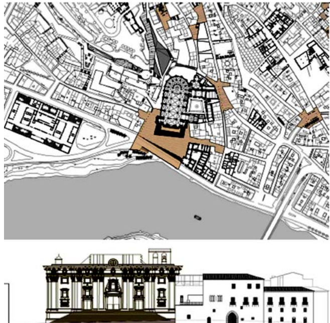
Figura 6.20: Detall de la intervenció que es vol efectuar davant la catedral de Tortosa per tal de que la seva façana sigui visible des de l'altra riba del riu Ebre. Font: Pla Integral del Casc Antic de Tortosa (2005).
