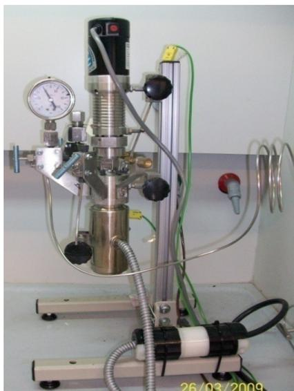
**Figura 8.** Montaje utilizado en el test catalítico de hidrogenólisis de glicerol.
