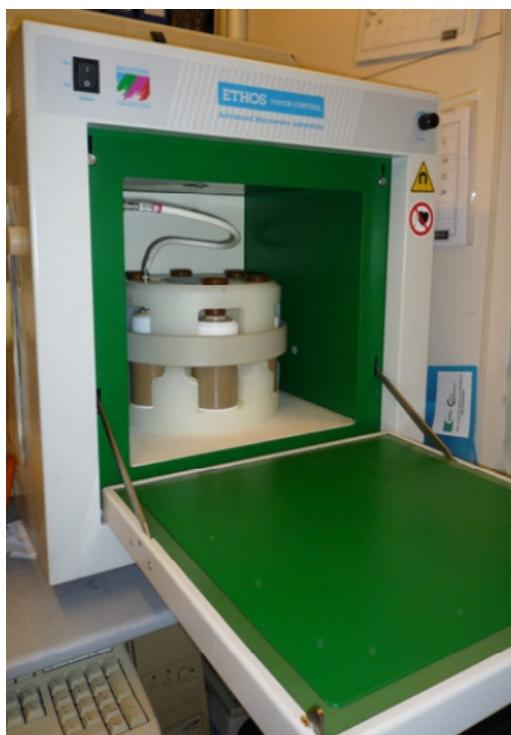
**Figura 3.** Equipo microondas (Milestone Ethos Touch Control)
