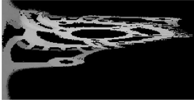
Figura 4.3: Imagen CIRCON de la carcasa de un alternador ( $\rho_\theta = 2,5^\circ$ ,  $\rho_r = 0,5mm$ ).
