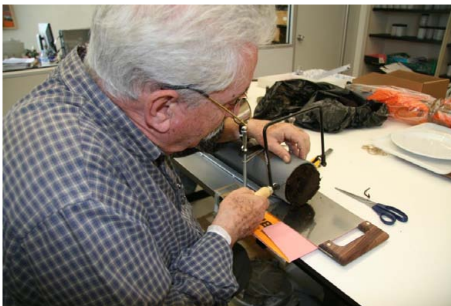
Figura 3.37. Mostreig de laboratori mitjançant el Grampeat
