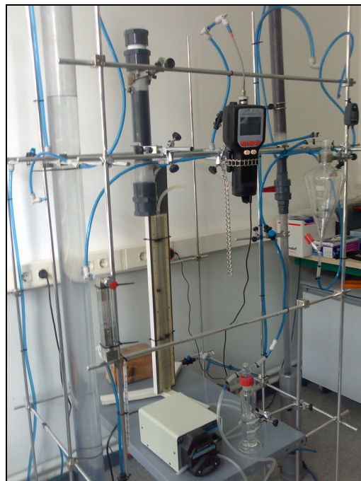
Figura 4.7: Fotografia del muntatge experimental per l'estudi de capacitats d'absorció i adsorció dels materials de rebliments en biofiltració.
