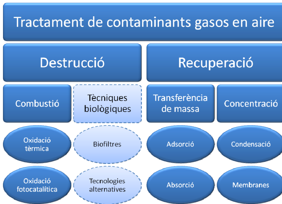
Figura 2.1. Classificació de les tecnologies més utilitzades en el tractament de contaminants gasosos en aire.
