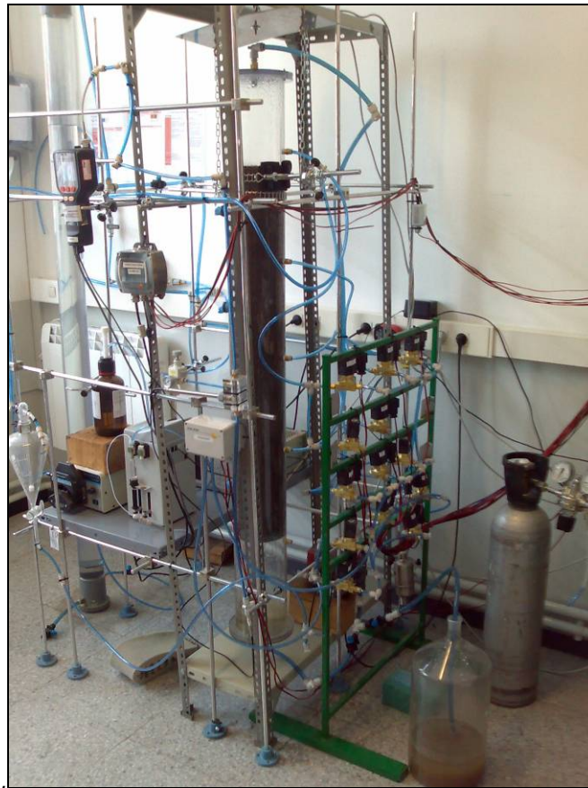
Figura 4.12. Fotografia del muntatge experimental pel seguiment del creixement de biomassa en biofiltració
