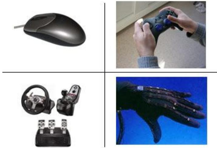
**Figura 5 - Dispositivos de entrada de información al Sistema de RV (ratón, yoystick, conjunto de volante, mandos y pedales y dataglove)**
