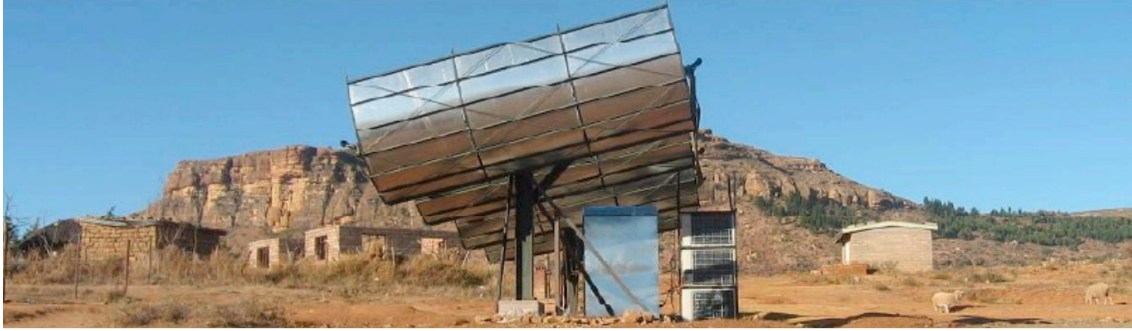
Figura 2.4. ORC solar de 1 kW en Lesoto [41].
