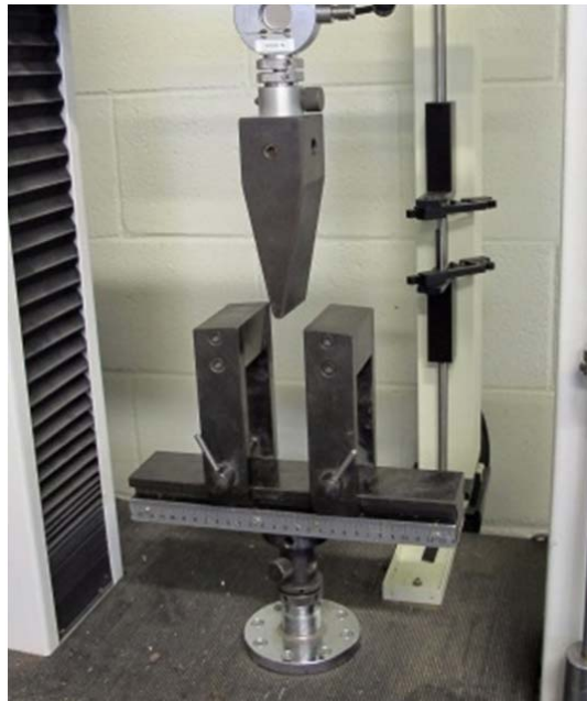
Figura 28: Detalle de la máquina universal para ensayos de flexión Instron 1122
