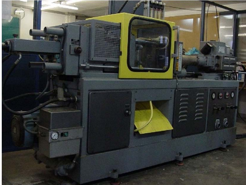
Figura 23: Equipo inyección Meteor-40
