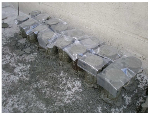
Figura A2. 23 – Fabricación de probetas cilíndricas de 150x300mm (primer camión)
