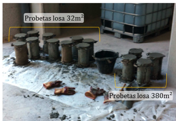
Figura A2. 36 –Probetas cilíndricas de 150x300mm
