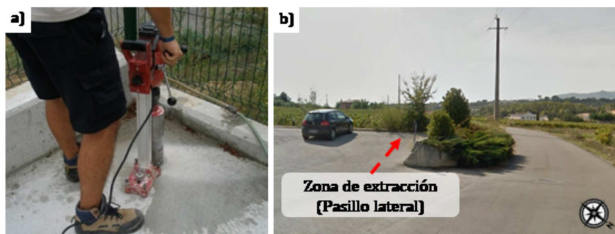
Figura A2. 17 – Testigo 3: (a) extracción y (b) localización del mismo
