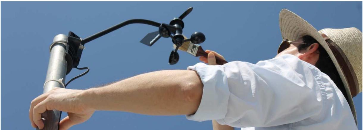
Figura 28 Limpieza del anemómetro de la estación meteorológica Davis. Fuente: Propia del autor.
