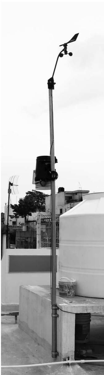
Figura 18 Mástil de fijación de la suite de sensores de la estación meteorológica. Fuente: Propia del autor.
