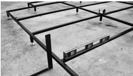
Figura 4 Nivelación de base metálica de Modelo Experimental. Fuente: Propia del autor.
