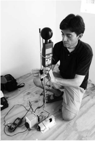
Figura 13 Instalación de anemómetro en punto HAB del interior de la habitación del Modelo Experimental (ME). Fuente: Propia del autor.
