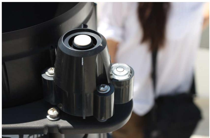
Figura 20 Sensor de radiación sola de la estación meteorológica Davis. Fuente: Propia del autor.
