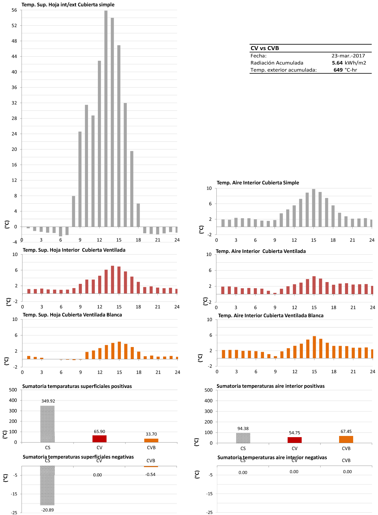
Gráfica 25: Graficas de los incrementos de temperatura que presentaron los diferentes puntos de medición de la Cubierta Ventilada (CV) y la Cubierta Ventilada con acabado de alta reflectividad solar (CVB).
