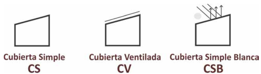
Figura 35: Esquema del grupo de medición utilizado para comparar el desempeño de la CV y el de la cubierta simple con aplicación de acabado de alta reflectividad.
