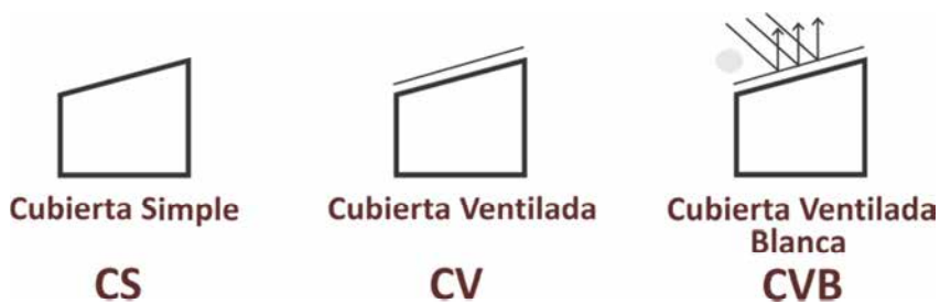
Figura 39: Esquema del grupo de medición utilizado para comparar el desempeño de la CV y el de la cubierta ventilada metálica con aplicación de acabado superficial de alta reflectividad para la hoja exterior.
