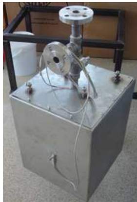
Figura III.6. Tanc emmagatzematge per calor sensible en sòlid disponible a la planta pilot.
