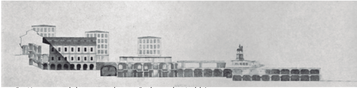
329. Sección este-oeste de la propuesta de 1931. Se observa el patio del Ayuntamiento del Sur con las vías de tren y la estación terminal de metro.
