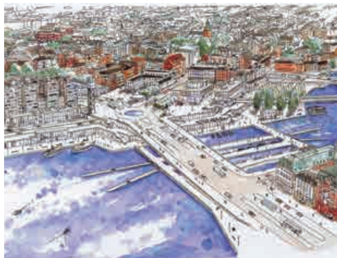
699. Acuarela de la propuesta ganadora de Nyréns arkitektkontor, Tyréns Stockholm y ELU konsult, 2003-2004. Se observan las dos rotondas dispuestas para organizar los flujos de tráfico en las cabezas de puente y la solución escalonada para matizar el desnivel. La propuesta también planteara dos edificios nuevos en la embocadura del túnel de metro y colmatando así la fachada de Södermalm. SÖRENSON, Ulf (ed.), Op. Cit. , p. 180
