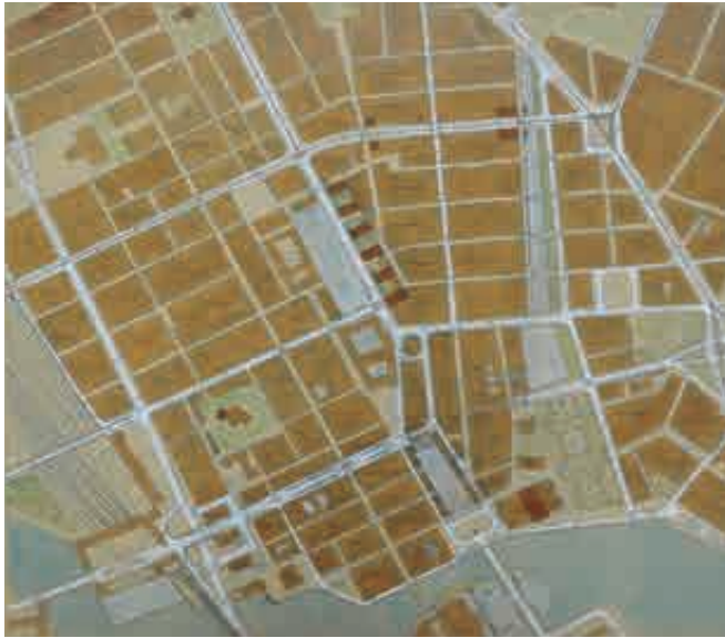
597. Planta de Norrmalm dibujada en 1934 donde se resalta en blanco las vías rápidas y en ocre las calles peatonales o de tráfico local. Una elocuente expresión de las teorías de la separación y diferenciación . Apuntar también el excesivo paralelismo con el Slussen en el proyecto dispuesto para Tegelbacken (inferior izquierda).
