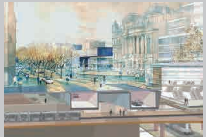
68. El despacho de Manuel de Solà-Morales, hoy JPAM Architecture & Urban Design, está trabajando para solucionar el espacio de Operaplein, sobre las huellas de los antiguos bastiones de Ambers. Allí confluirán, a diferentes cotas, el ferrocarril, una autovía urbana soterrada, un aparcamiento, tranvía y un espacio público de máxima centralidad. Un claro ejemplo de proyecto de articulación en un lugar intersticial.
