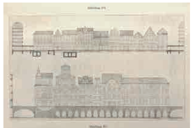
293. Propuesta de Hans Ludwig Sierks para solucionar las intersecciones en el centro de Warsaw mediante viaductos elevados. En amarillo se muestra la calle en cota 0, en rojo el viaducto en la +1 y en azul el espacio reservado a las rampas. Las secciones muestran la plaza central de la ciudad con el nuevo soportal generado por el viario.
