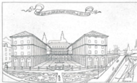
263. Perspectiva, sección y plantas de Tage William-Olsson para convertir el Ayuntamiento del Sur en estación ferroviaria. Destaca aquí la extensión del volumen como una interpretación del proyecto original de N. Tessin y el encaje a diferentes cotas de la conexión entre ambos lados. (izquierda) Elaboración propia sobre documentos en WILLIAM-OLSSON, Tage, "Ett nytt uppslag i Stockholms bangårdsfråga", Byggmästaren , pp. 135-136, 1924. (inferior arriba) WILLIAM-OLSSON, Tage, "Södra Stadshuset och järnvägen", Byggmästaren , 1924, pp. 137 y 138 (inferior debajo) Elaboración propia sobre base facilitada por Stockholm Stadsmuseet- Frihamnen
