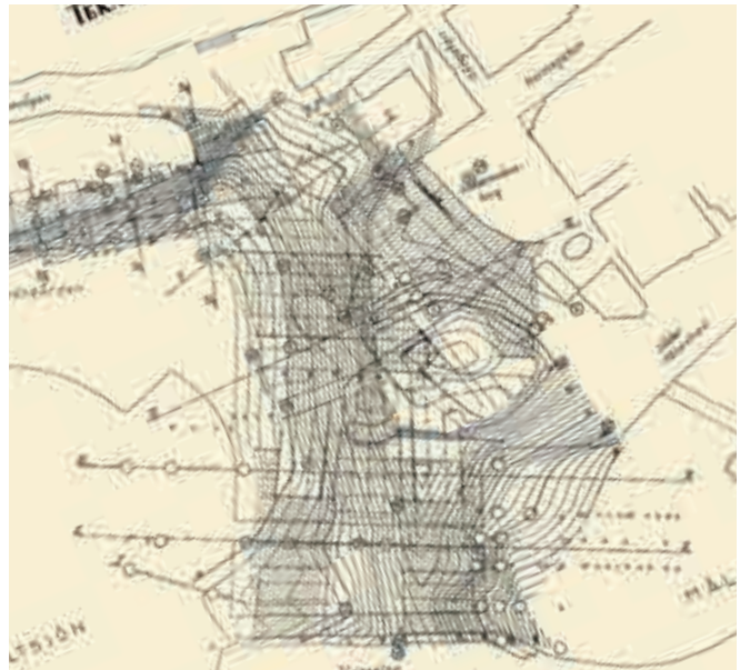
393. Plano topográfico del subsuelo modificado por el Slussen de 1935. BJUKE, Carl, "Grundläggning vid Slussen i Stockholm medelst pålning enligt system Franki", Teknisk Tidskrift , 1936, p. 122
