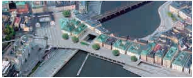
745. Propuesta Stråk de Fredrik Falk para el Slussen, 2007. Bajo la gran plataforma discurren los tráficos rápidos y en superficie se extiende Gamla Stan para conseguir así espacios públicos de dimensión reducida. ¿Jean de la Vallée de nuevo? http://www.glittra.com/nyaslussen/
