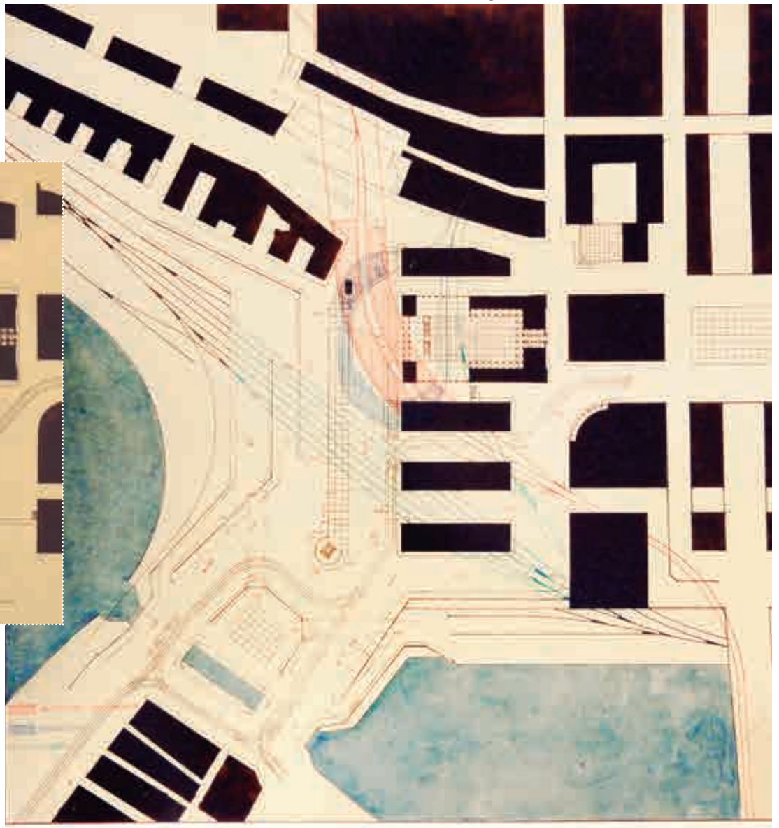
276. Derecha, planta de la propuesta de agosto de 1929 con el dibujo de las líneas ferroviarias propuestas tras la eliminación del puente central existente: en azul se plantea una estación terminal de la línea de Gröndal (cerca de la actual L22) aprovechando el túnel que ocupaba antes la línea de tren norte-sur; en verde se marcan los trenes del puerto; y en rojo se propone un "lokbanen" o lo que luego será el metro. A la izquierda se muestra un detalle de la arquitectura, con su solución de pórtico perimetral, escaleras y accesos a la cota -1 (izquierda) ArkDes (derecha) SSA
