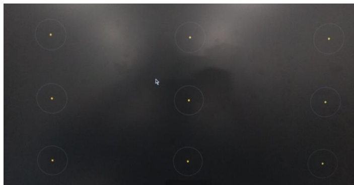
Imagen 9. Imagen de calibración del sistema. Se muestran los puntos de calibración sobre los que debería fijar los ojos (círculos amarillos dentro de círculos blancos) para confirmar que la calibración es correcta.
